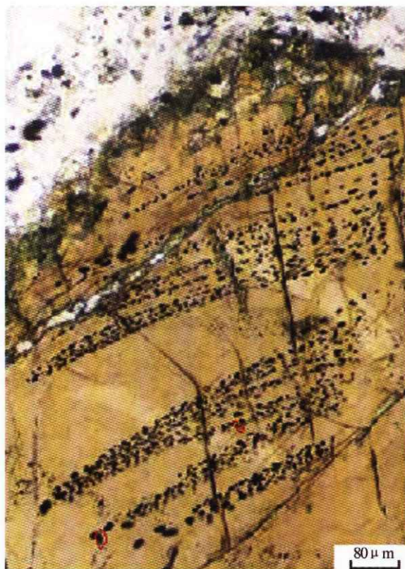
B 角闪石巨晶中束状排列的磁黄铁矿-黄铜矿 (单偏光, 样品号: CS-1-3)
